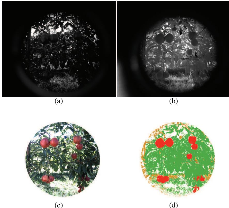
Fig. 2. Experimental results. (a) 635 nm image. (b) 880 nm image. (c) RGB image of the apple orchard. (d) Classification map.
